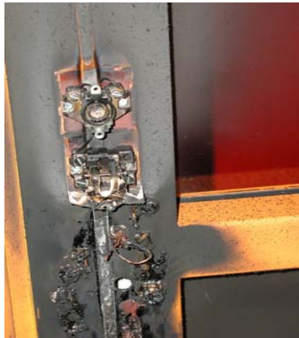
Bild 4 Följden av att för stor last kopplats till en belysningsregulator. Elapparaterna fungerar i allmänhet utan övervaknings, som i detta fall på veckoslutet! Bild J Kor-
